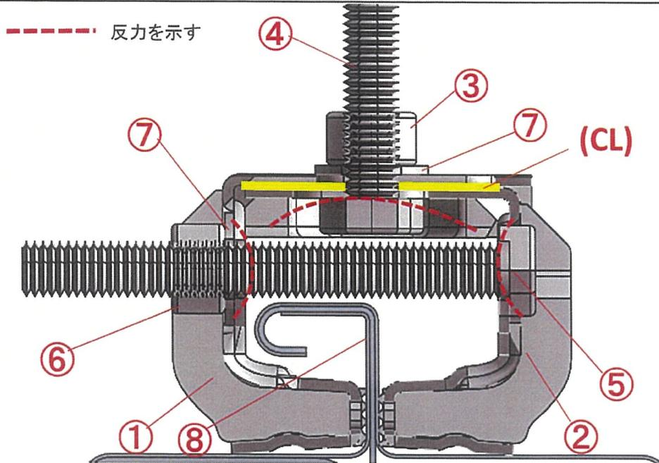
図BはOTハゼグリップをハゼ板に取り付けた状態のA-A断面図を示す。
